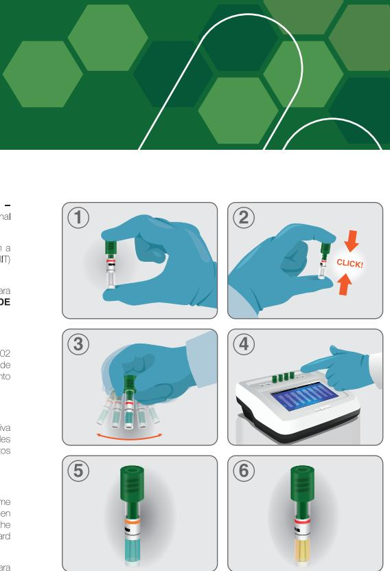
**IMPORTANTE:** transportar, armazenar, ativar, incubar e descartar sempre na posição vertical (tampa para cima) para evitar vazamentos após a ativação do produto.
